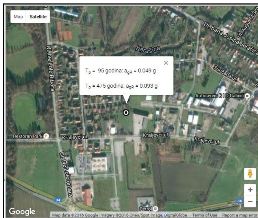
Slika 6: Horizontalna vršna ubrzanja tla tipa A ( a_{gR} ) za povratna razdoblja od T_p = 95 i 475 godina za predmetnu lokaciju
